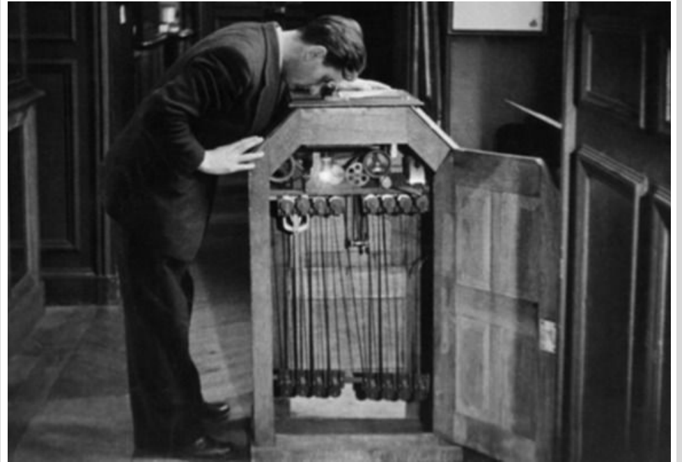
Homem assistindo filme no cinetoscópio, que se encontra aberto e é possível visualizar os rolos de filmes
